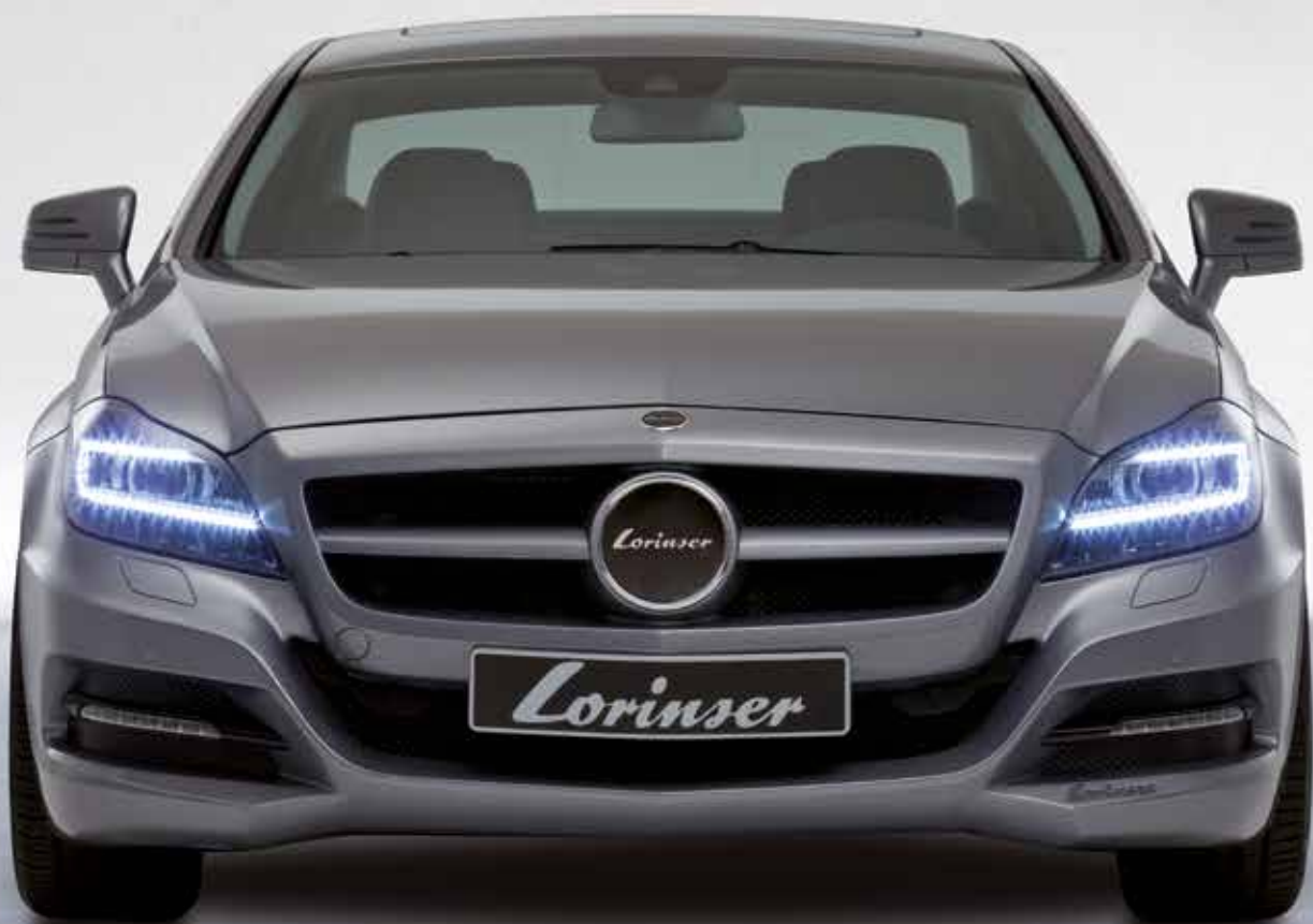
Spoilerstoßfänger mit eingebetteten LED-Tagfahrlichtern.
